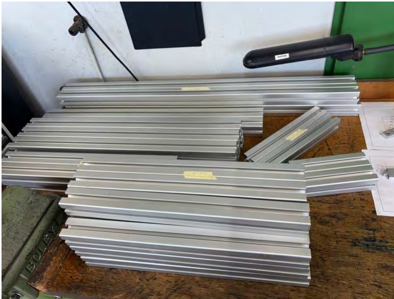
Abb. 3-7: Zuschnitt der Aluminiumprofile in der Werkstatt.
