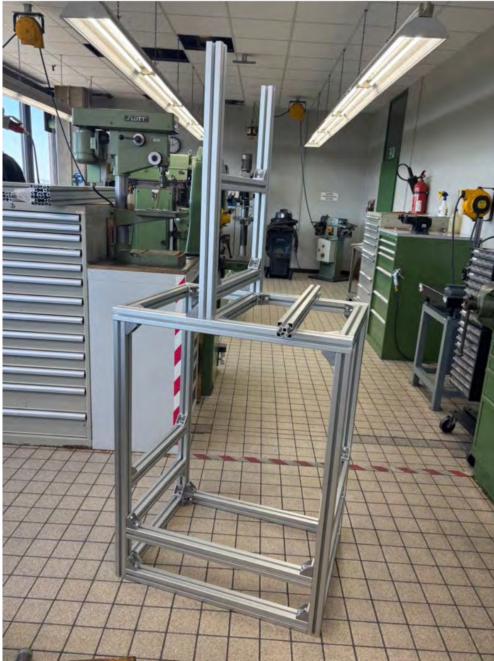
Abb. 3-9: Konventioneller Aufbau des Grundgestells in aufrechter Position.
