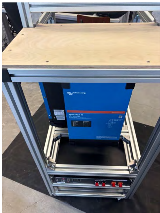
Abb. 3-15: Befestigte Holzplatte auf der obersten Rackebene.
