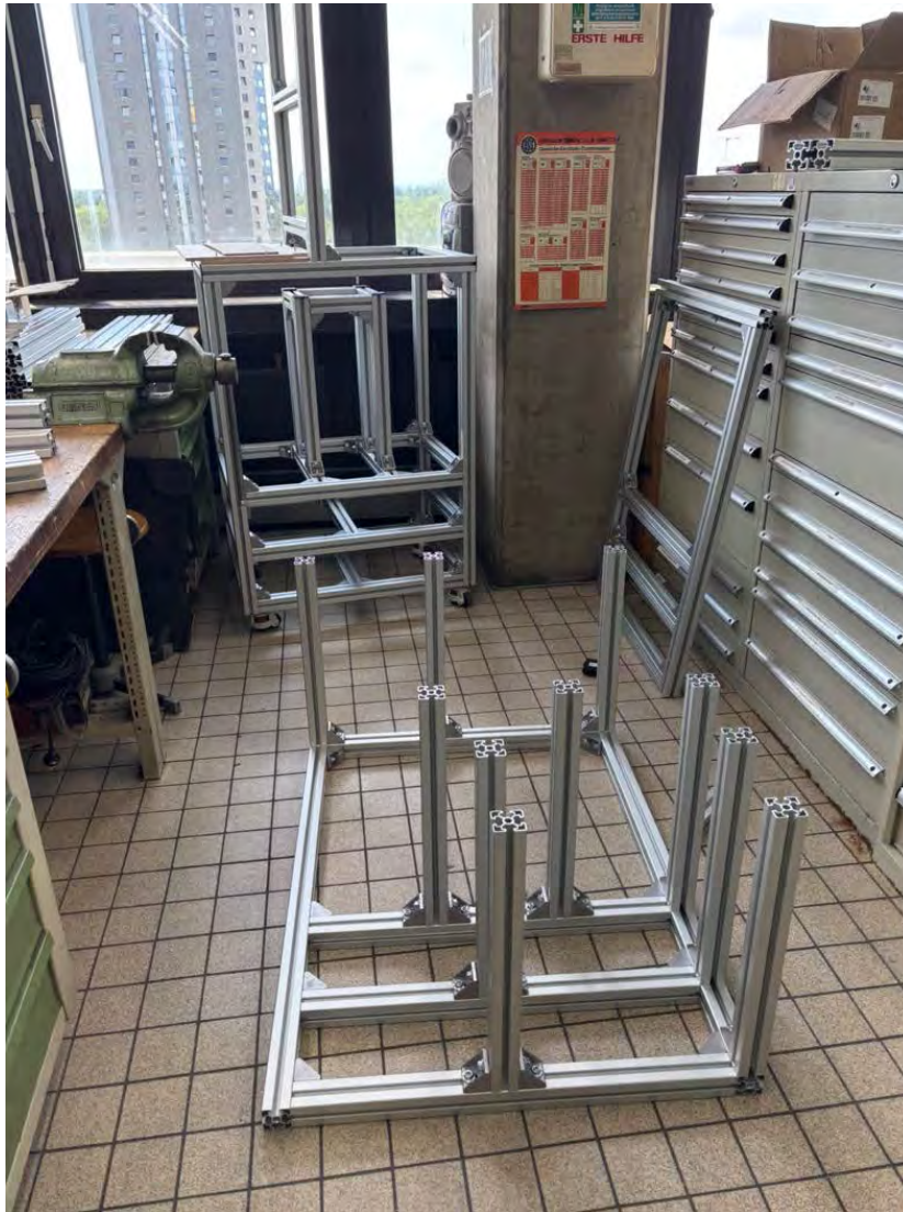
Abb. 3-10: Zusammenbau der Seitenrahmen mit definierten Einbaumaßen.
