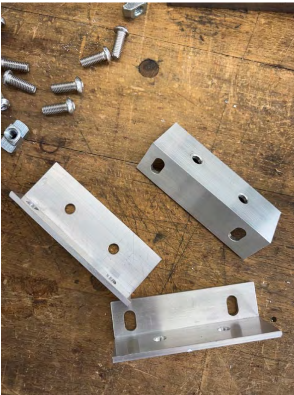
Abb. 3-13: Fertig gefräste Batteriehalterungen aus Aluminium mit Bohrungen und Langlöchern.
