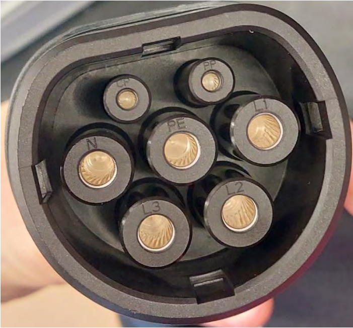
Abbildung 11 Typ 2 Stecker und Belegung 1
