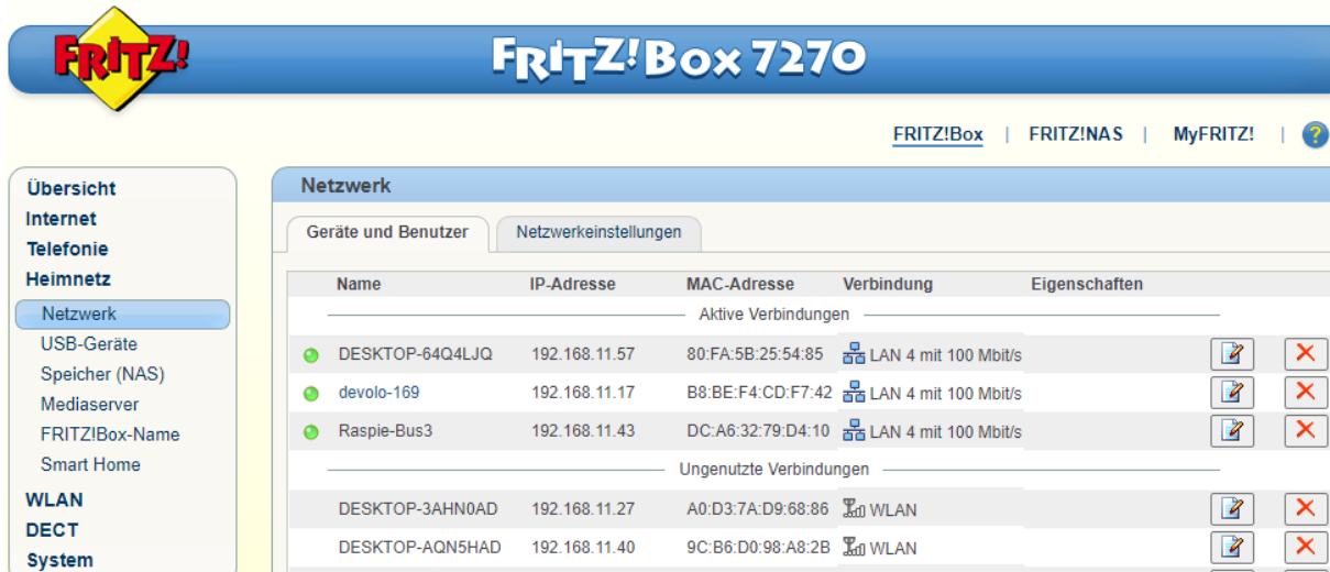
Abb. 31: Raspberry Pi mit zugewiesener IP und Namen Raspie-Bus3
