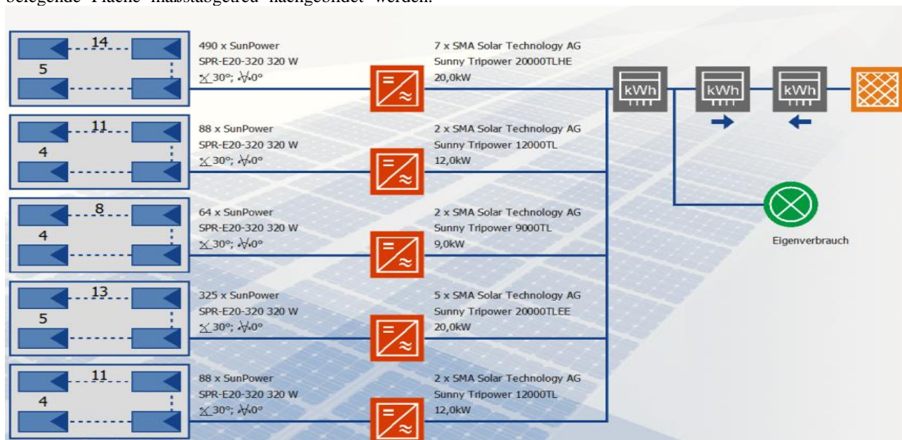
Abbildung 7: PV-Sol-Verschaltungsplan des PV-Systems.
